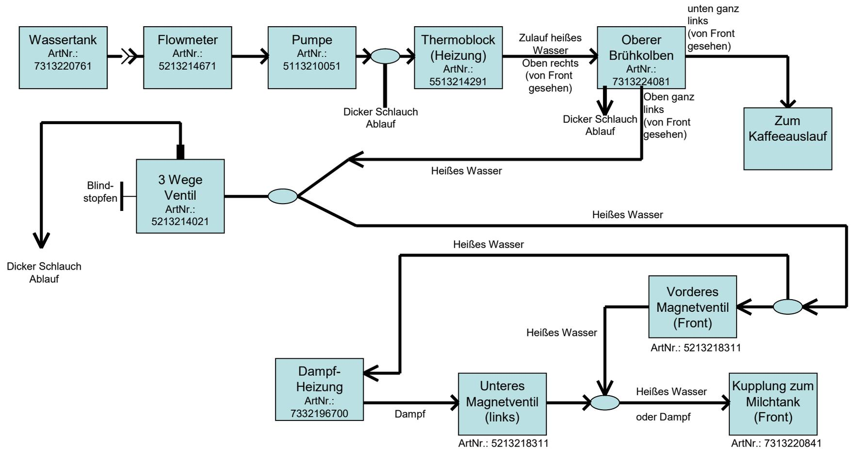
Vorderes Magnetventil öffnet -> aus der Kupplung kommt heißes Wasser
