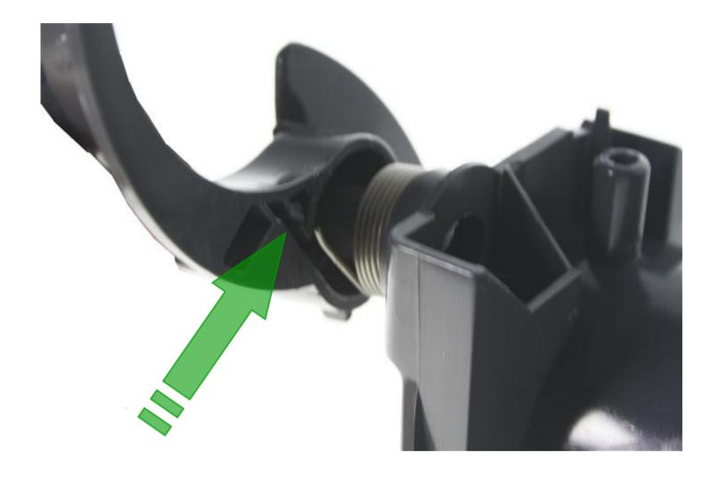
Jetzt können Vorderseite und Hinterseite wieder zusammengefügt werden. Hierfür muss der Auswurfhebel über das Sieb geschwenkt und gehalten werden. Der Auswurfhebel muss ganz nach unten gedrückt werden, siehe Bild (2)
