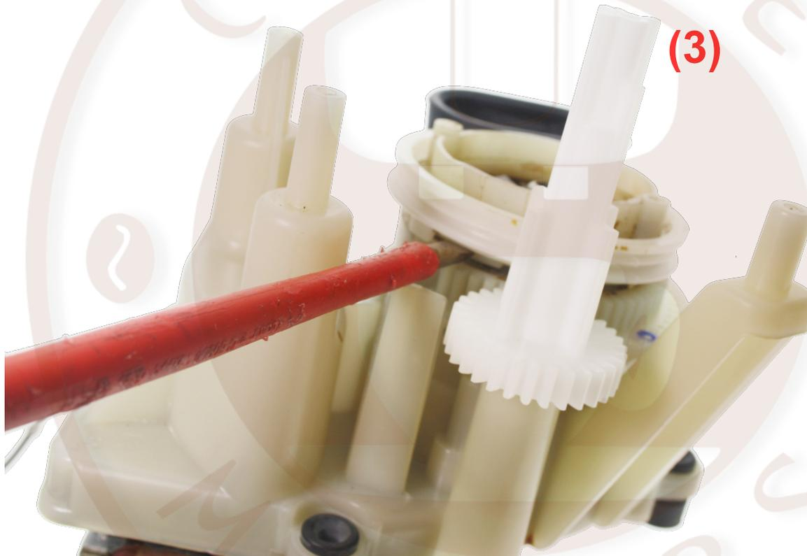
Den Mahlring (1) so stellen, dass die werkseitige Markierung (2) so steht wie auf dem Bild zu sehen. Die Mahlgradverstellachse (3) hat oben eine kürzere Seitenflanke (▲). Die Mahlgradverstellachse sollte dann so stehen dass diese ca. 4-5 Zähne von der blauen Markierung (2) auf dem Mahlring entfernt ist.
