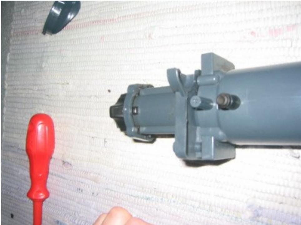
10. Den Innenteil des Brühkolbens entfernen
