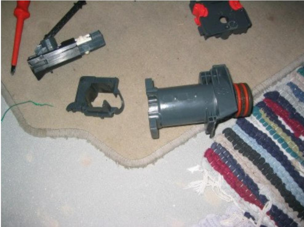
12. Schraube die das Sieb hält vom Brühkolben entfernen
