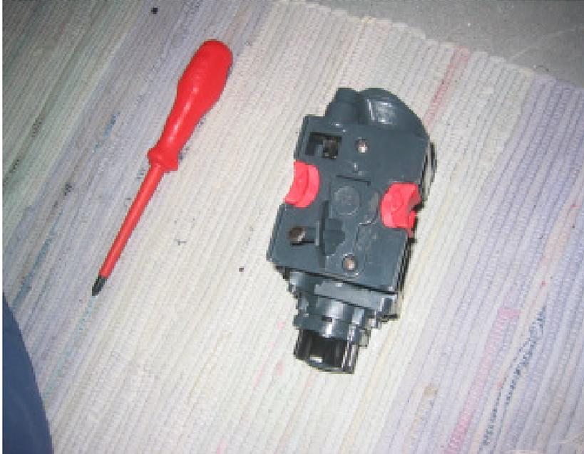
2. Den Kaffeeauslauf entfernen und danach die darunter verborgene Schraube entfernen
