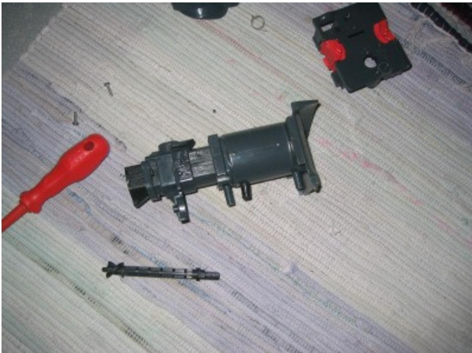
9. Die Halteklammer die die Einzelteile des Brühkolbens zusammenhält aushebeln und entfernen
