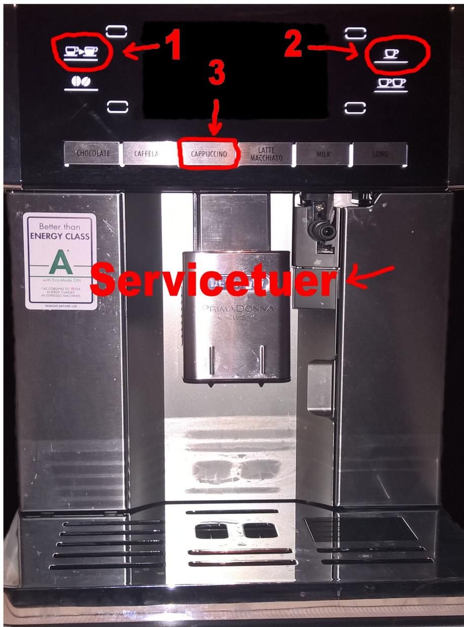
Hauptschalter auf der Geräterueckseite auf 1 Stellen ( KVA muss im Standby sein , TFT Bildschirm dunkel ). Die Servicetuer Oeffnen , Taste 1 , 2 , 3 solange gleichzeitig druecken bis SELECT TEST MODE im TFT Bildschirm erscheint , jetzt die 3 Tasten loslassen und die Servicetuer schliessen , innerhalb 1 - 2 Sekunden einen Testmode auswahlen .
