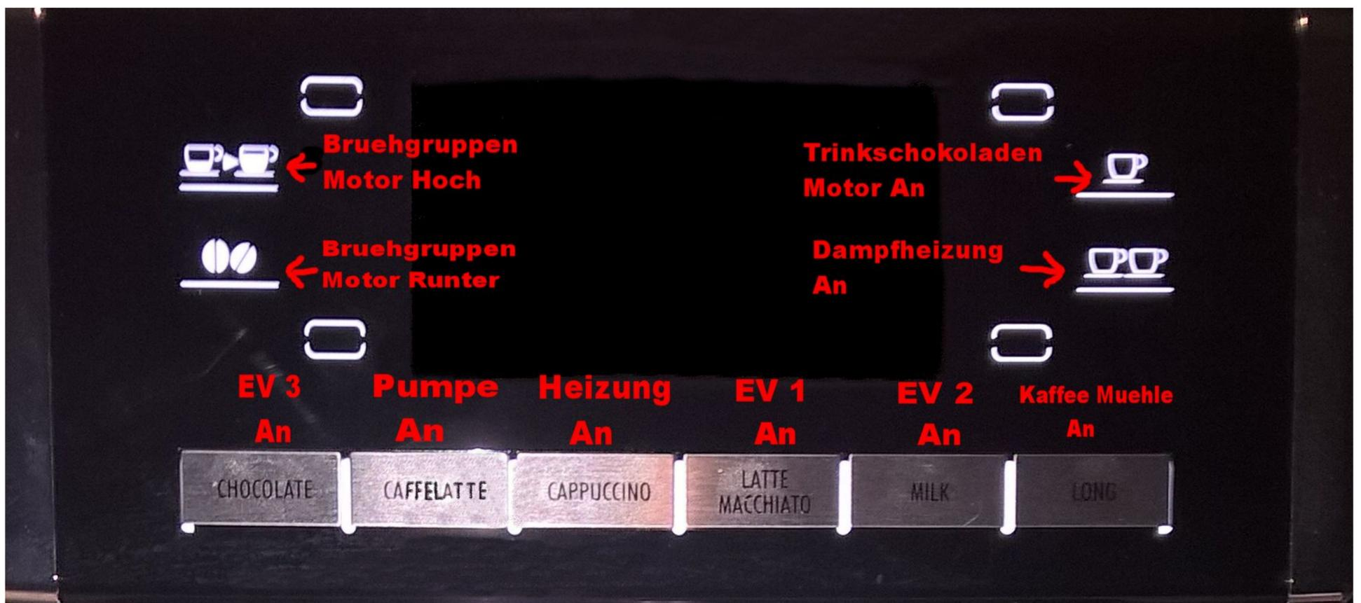
**ZUM VERLASSEN DES POWER LOAD TEST DEN HAUPTSCHALTER AUF 0 !**
