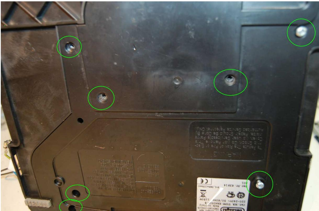
2 Kreuzschlitzschrauben entfernen.
