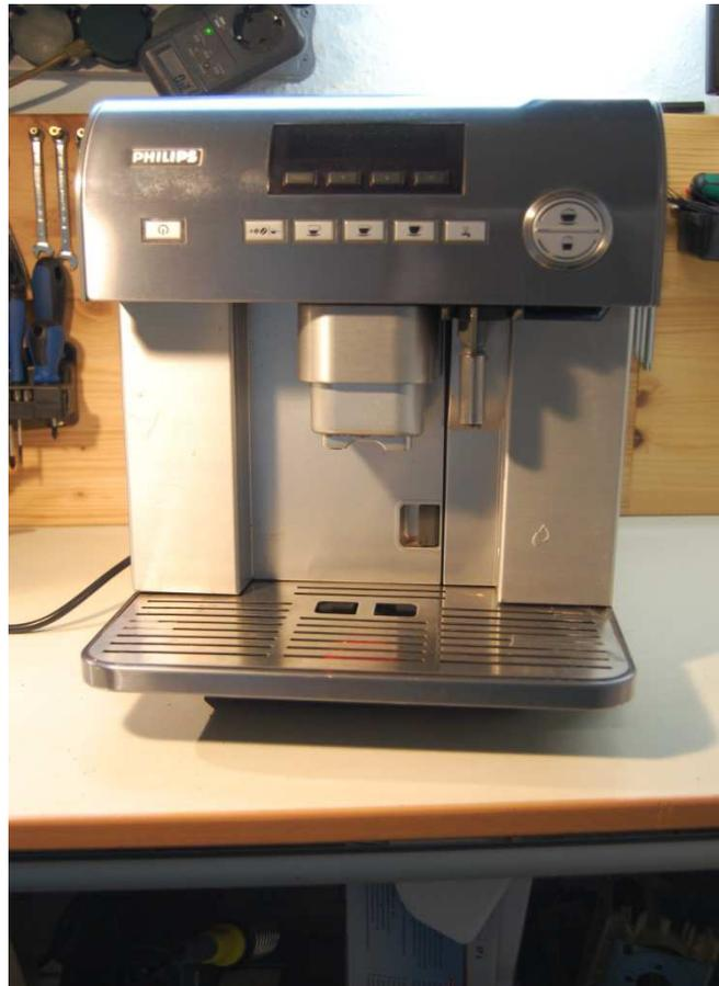
Ich habe dann über den Testmodus zuerst einmal alle Funktionen überprüft. Soweit hat alles funktioniert. Der Antrieb quietschte und die Brühgruppe ging sehr schwer. Also etwas Silikonfett auf die Antriebswelle und die Brühgruppe zerlegt und ab in die Spülmaschine damit.
