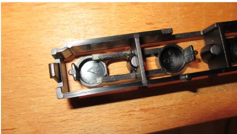
10. Die Tastenleiste wieder einbauen. Leiste oben oder unten zuerst mit dem Klemmstecker einstecken und dann am anderen Ende einrasten.
