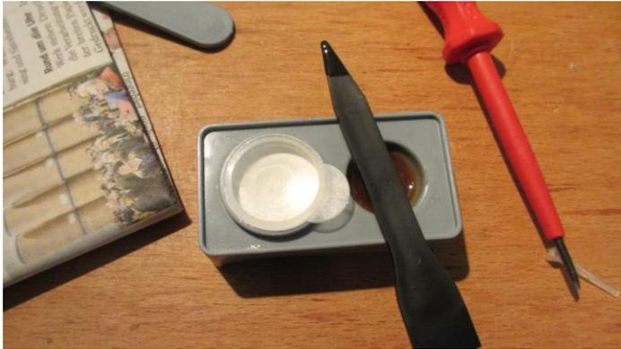
9. Druckknopf ankleben und ggf. mit Kunststoffschienen stabilisieren (habe ich aus Kabelbindern erstellt). Diese hierzu mit Kleber beschichten und mit einer Pinzette auflegen. Die Leiste flach auf den Tisch legen und den Schalter sauber ausrichten.
