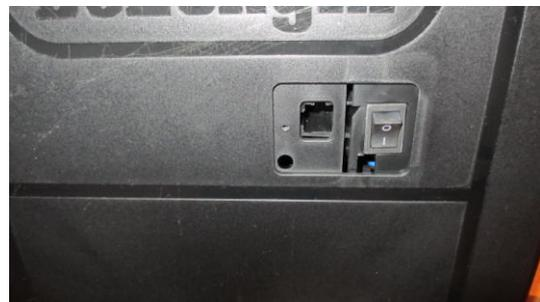
2. Seitenteile abnehmen, hierzu die 2 linken und 2 rechten Schrauben von hinten herausdrehen Bild 3 zeigt die Maschine von hinten, Bild 4 eine der Schrauben.
