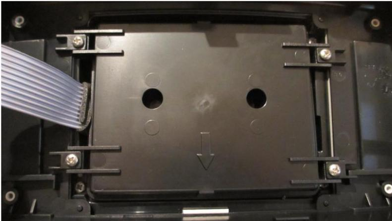
6. Rückwand des Bedienteils entfernen, 4 Schrauben herausdrehen, Bedienteil nach vorne abnehmen, Vorsicht, dass es nicht nach dem lösen herunterfällt.
